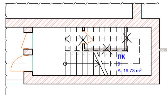
Дст - демонируемые стены из кирпича
