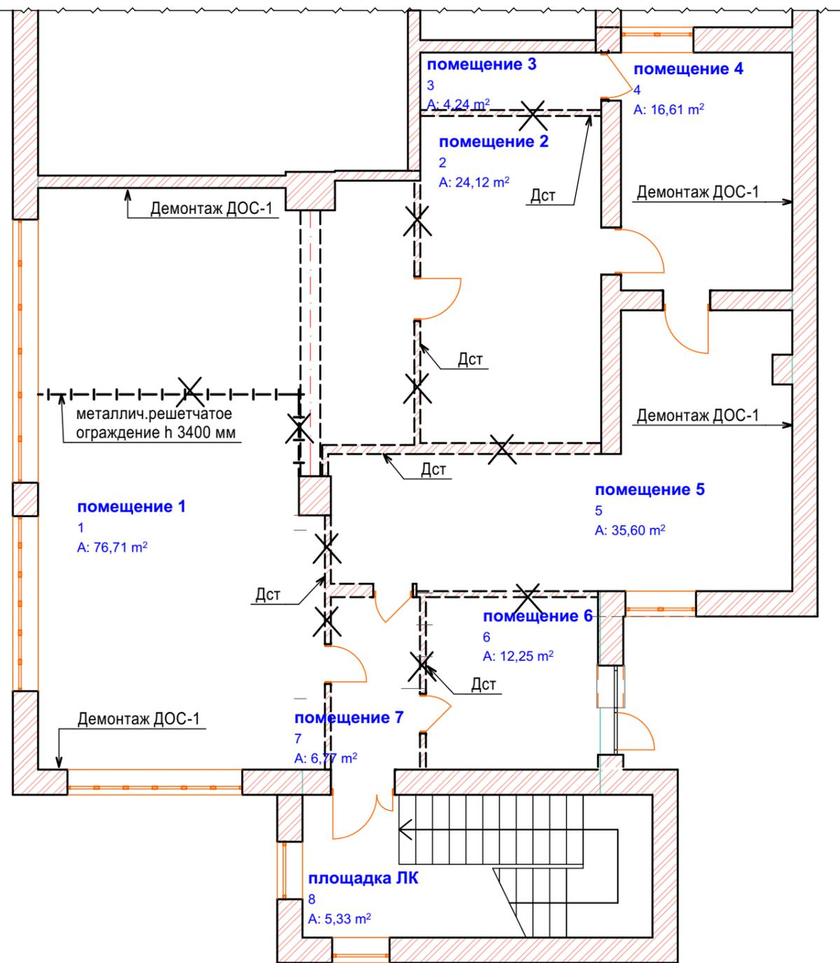
План демонтажа 1 этажа.
