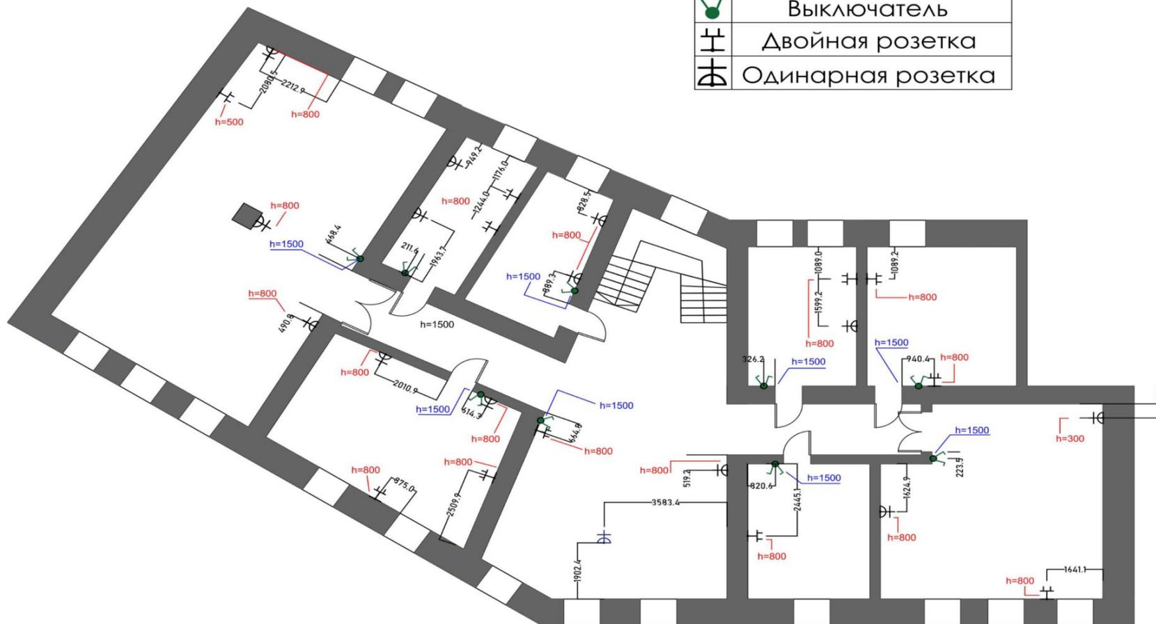
Рис.3 План расстановки розеток и выключателей
