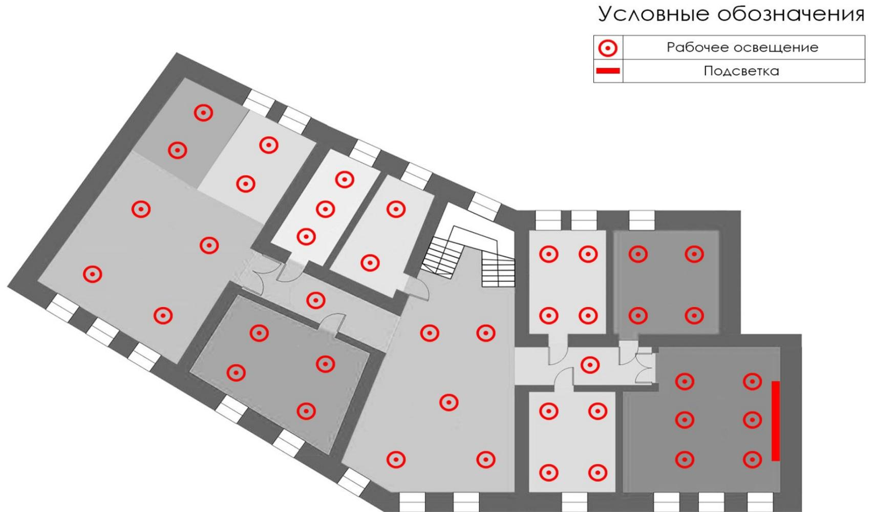
Рис.4 План расстановки светильников
