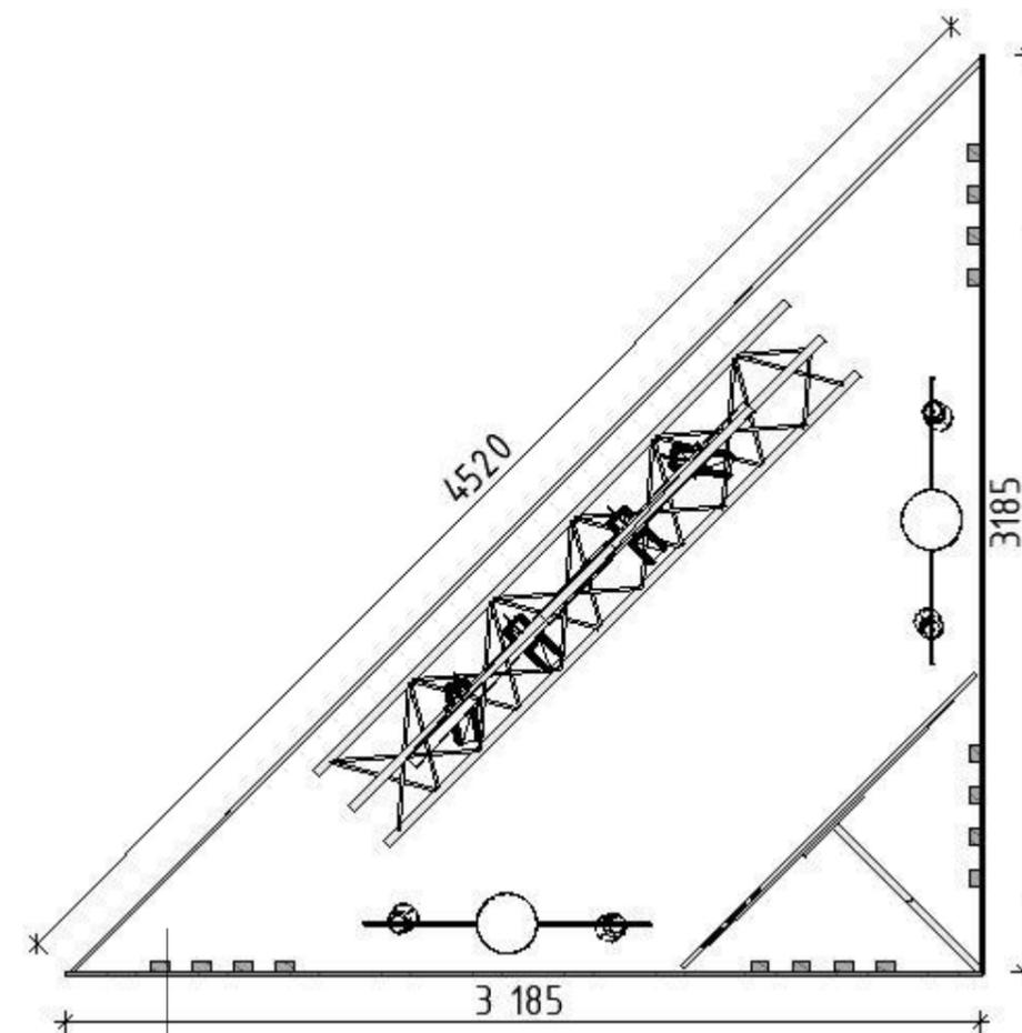
Подиум: основа металлический каркас из профильной трубы с деревянными лагами, отделанной ламинатом по фанерной (12 мм) подготовке.
