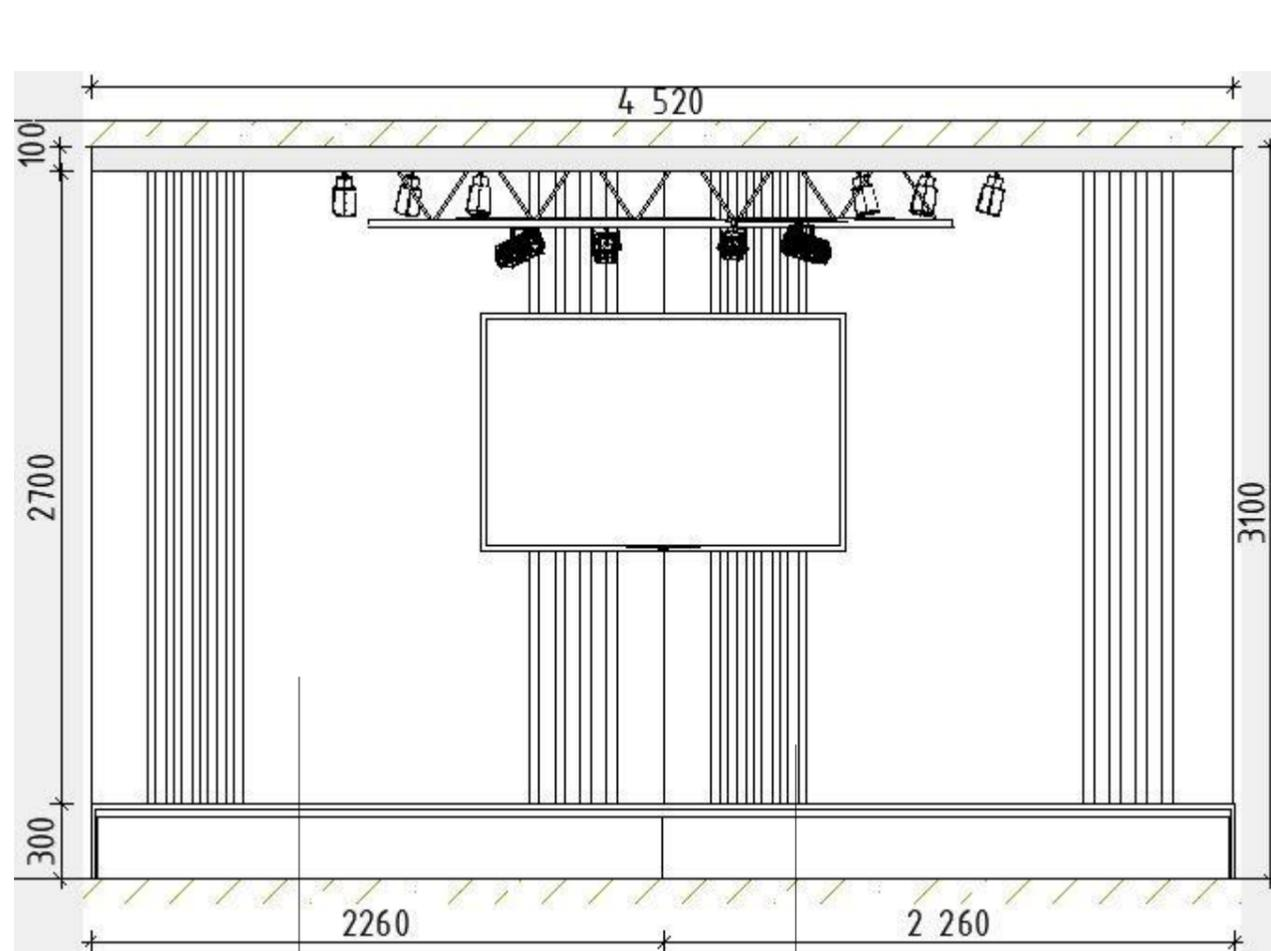
На стене: металлопрофиль ПН, ламинат по фанерной (с антипиреновой обработкой) подготовке (12 мм)
