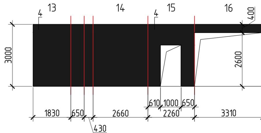
Развертка стен медиа модуля, М 1:100
