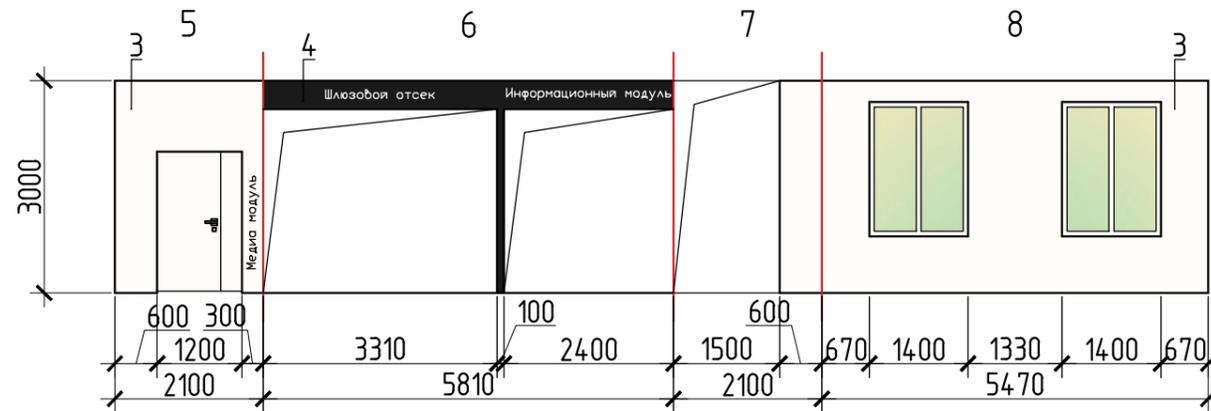
Развертка стен информационного модуля, М 1:100
