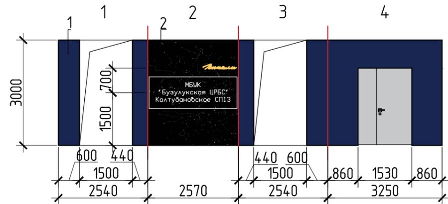
Развертка стен обзорного модуля, М 1:100
