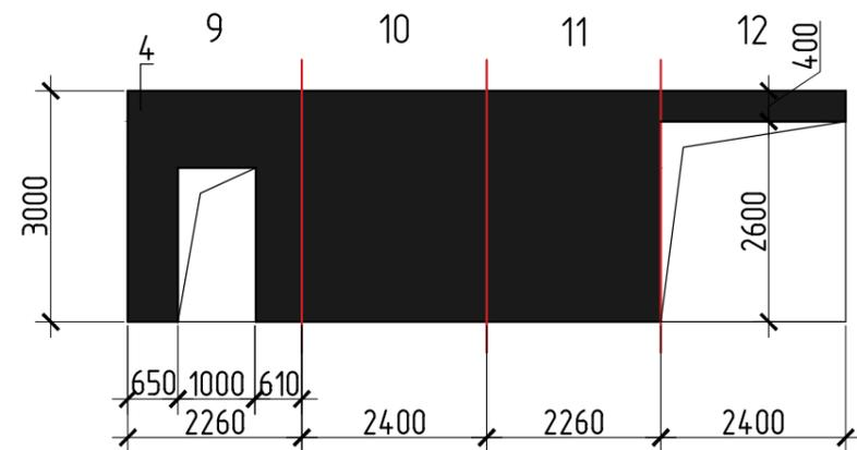
Развертка стен шлюзового отсека, М 1:100
