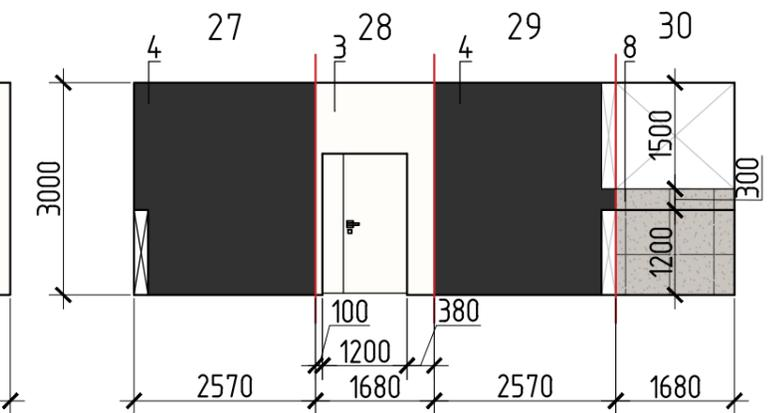
Развертка стен многоцелевого модуля, М 1:100
