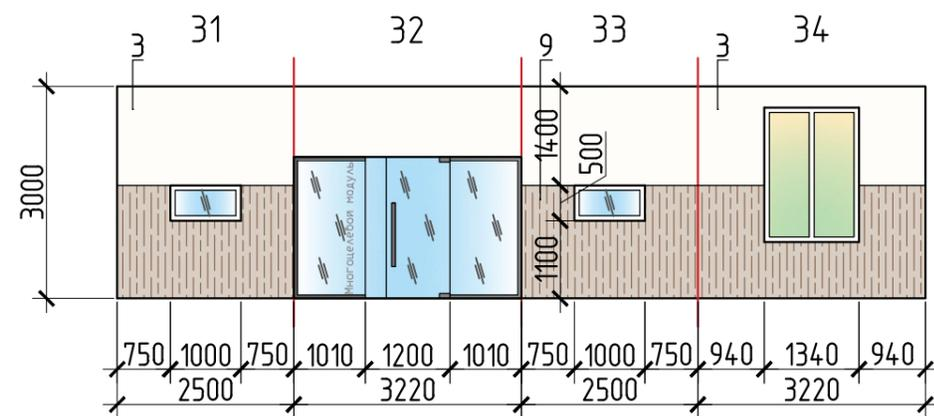
Развертка стен модуля спокойствия, М 1:100
