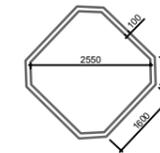
Схема конструкции поддона для кашпо с пальмами (разрез)
