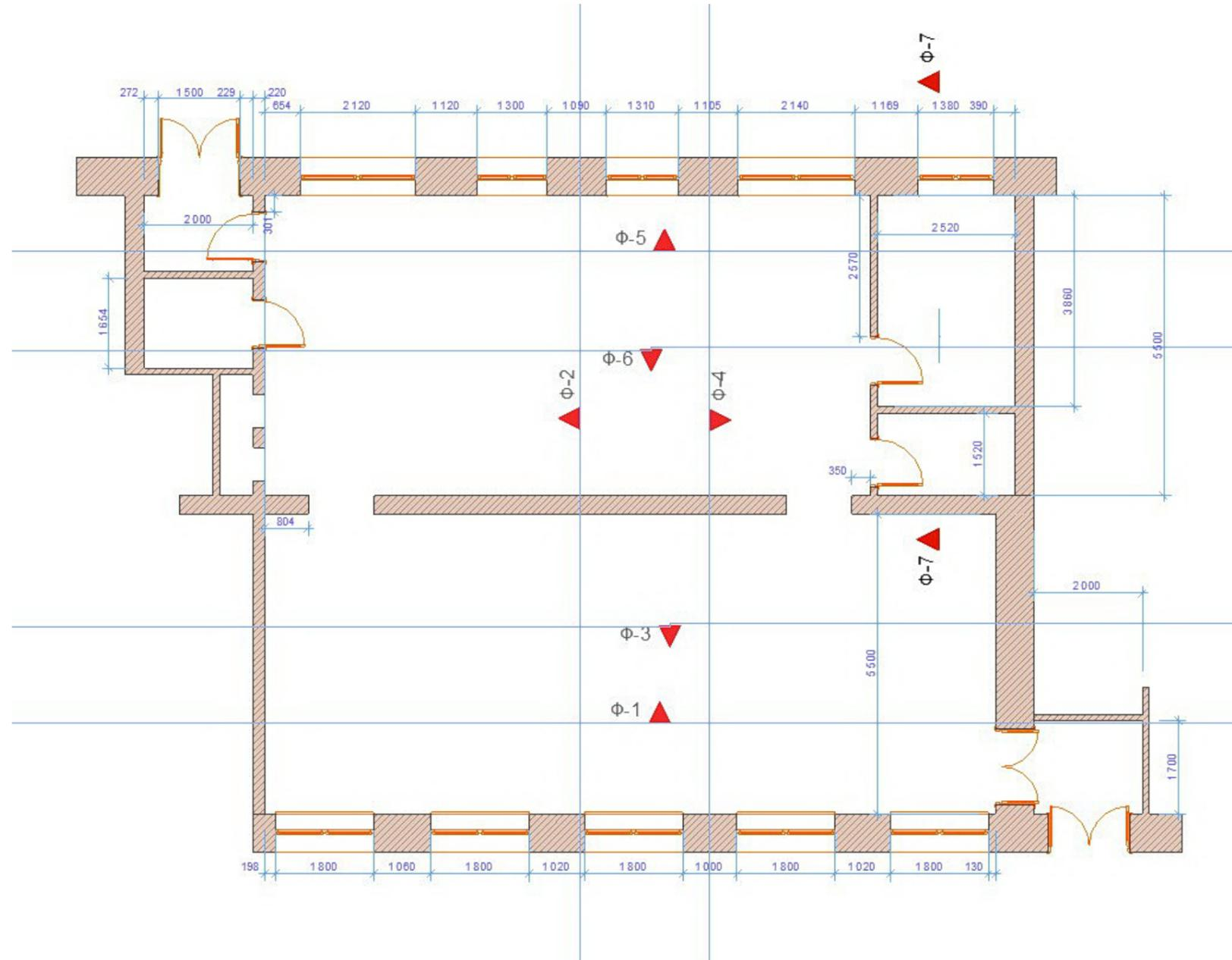
Развертки стен с размещением оборудования М1:100
