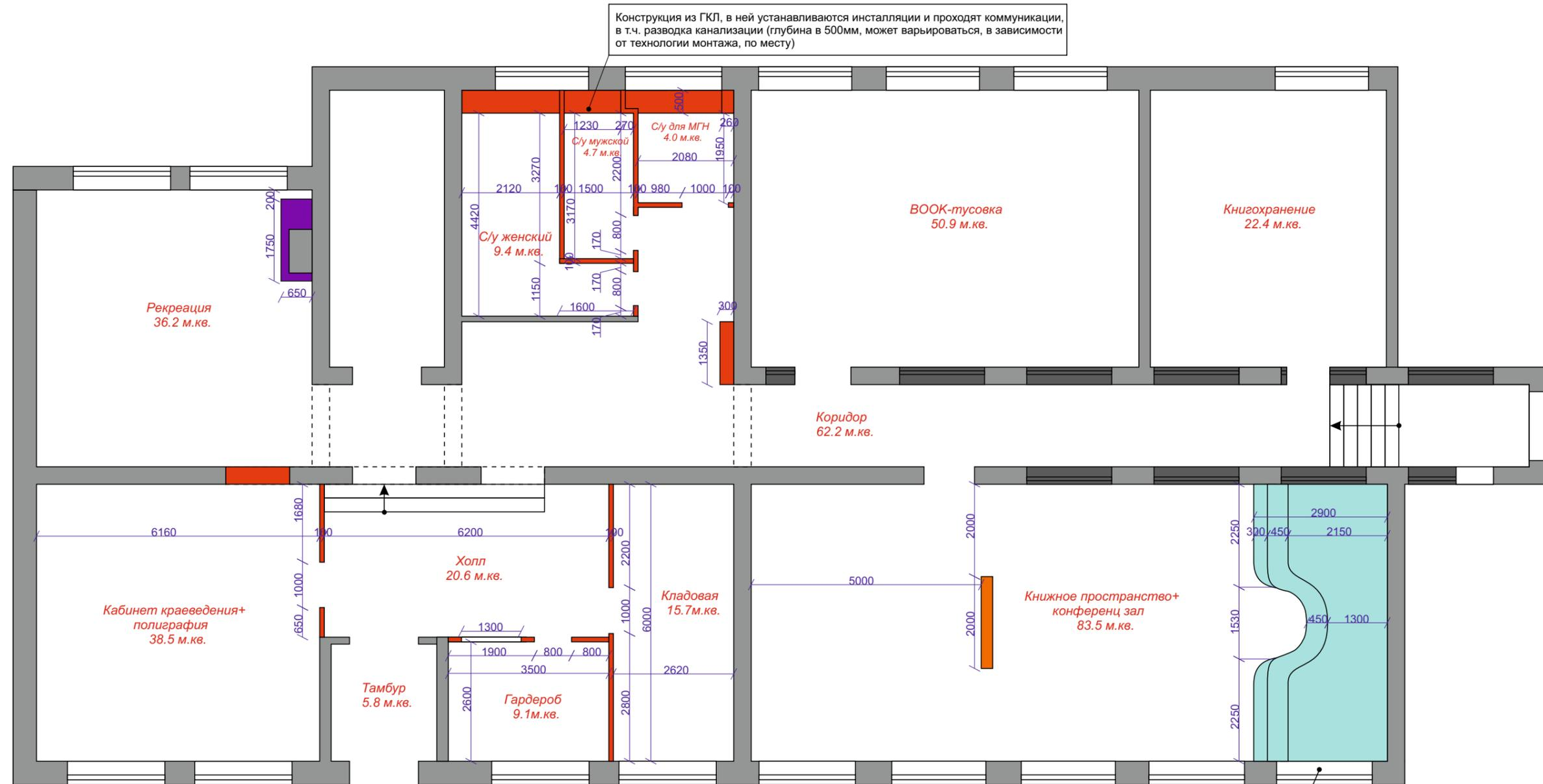
План монтажных работ 2 этажа
