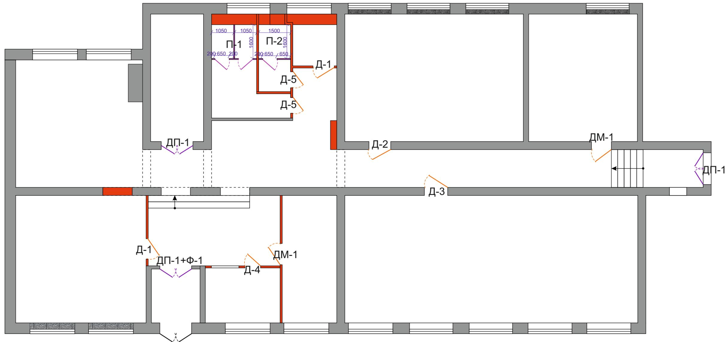
План заполнения дверных проемов 2 этажа
