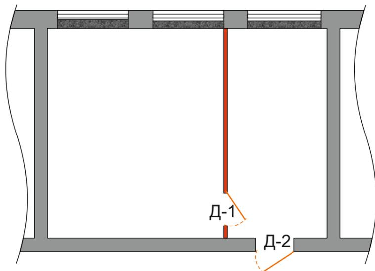
Спецификация заполнения дверных проемов 1 и 2 этажа
