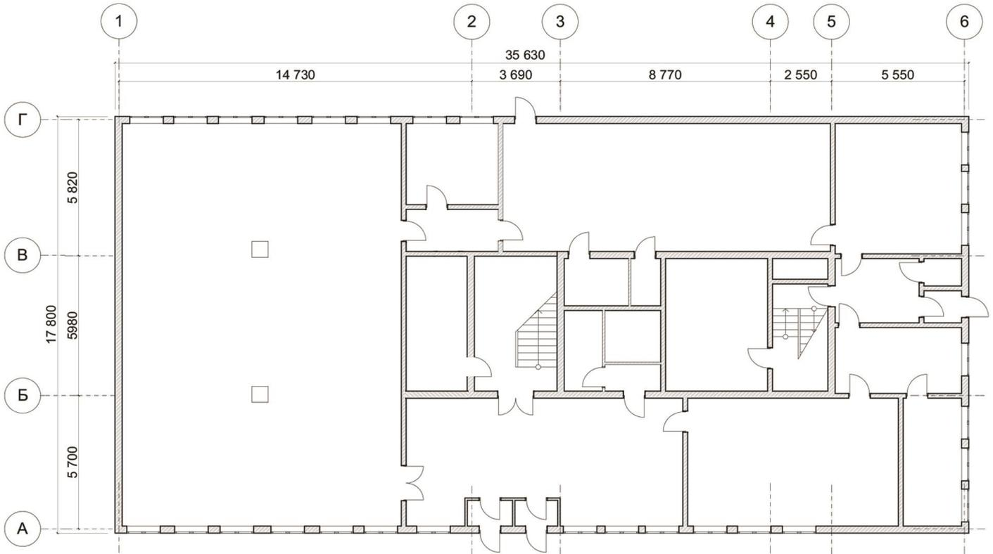
Схема функционального зонирования 1ого этажа М 1:100:
