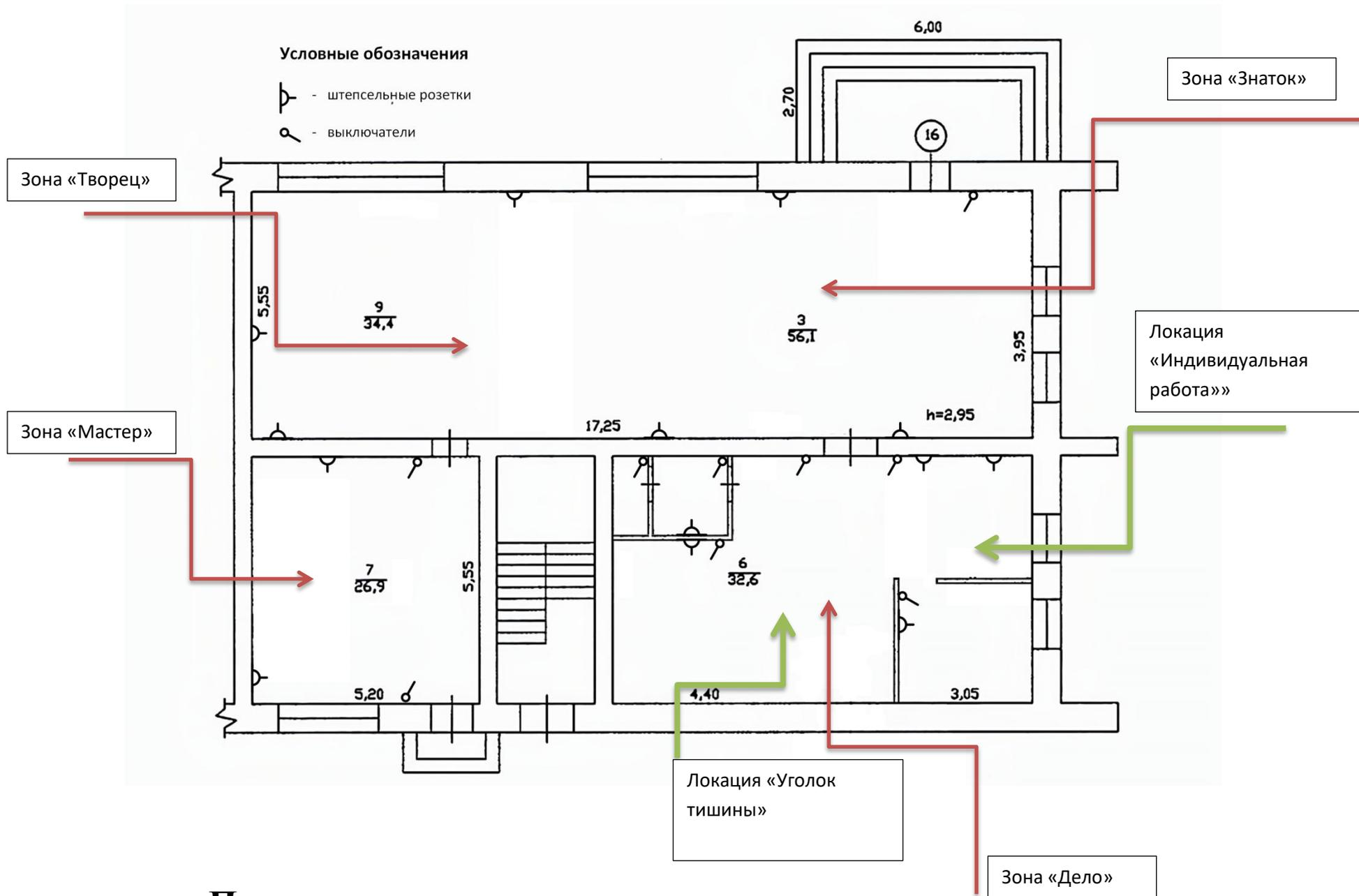
**План расстановки электрических розеток и выводов**
