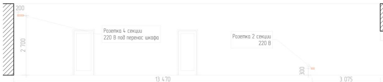
Размещение розеток и выключателей Разрез 4-4
