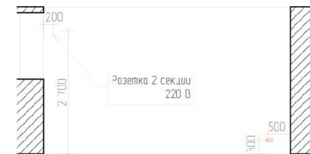
Размещение розеток и выключателей Разрез 8-8
