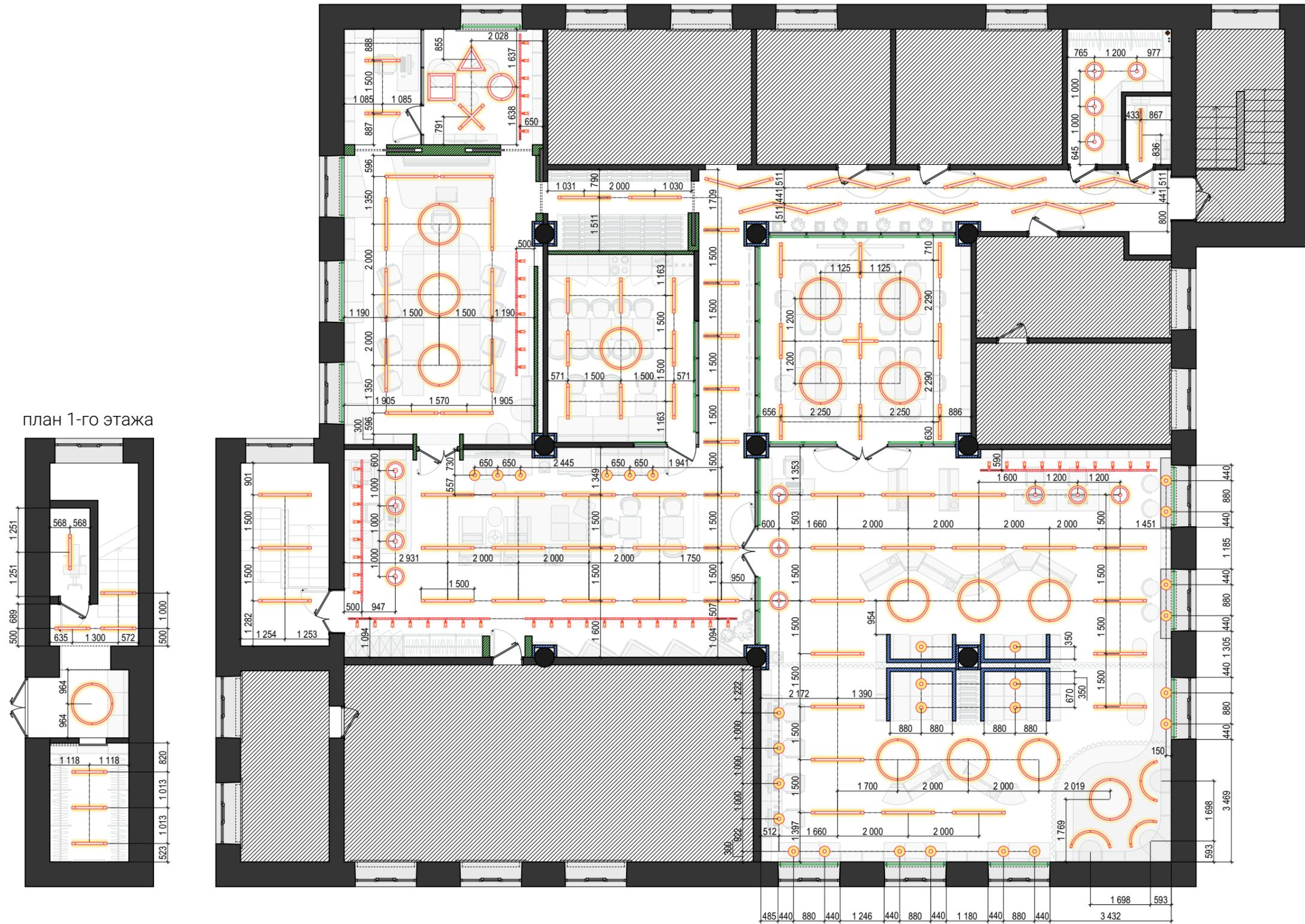
ПЛАН РАСПОЛОЖЕНИЯ ЭЛЕКТРИКИ (спецификация электрических розеток)
