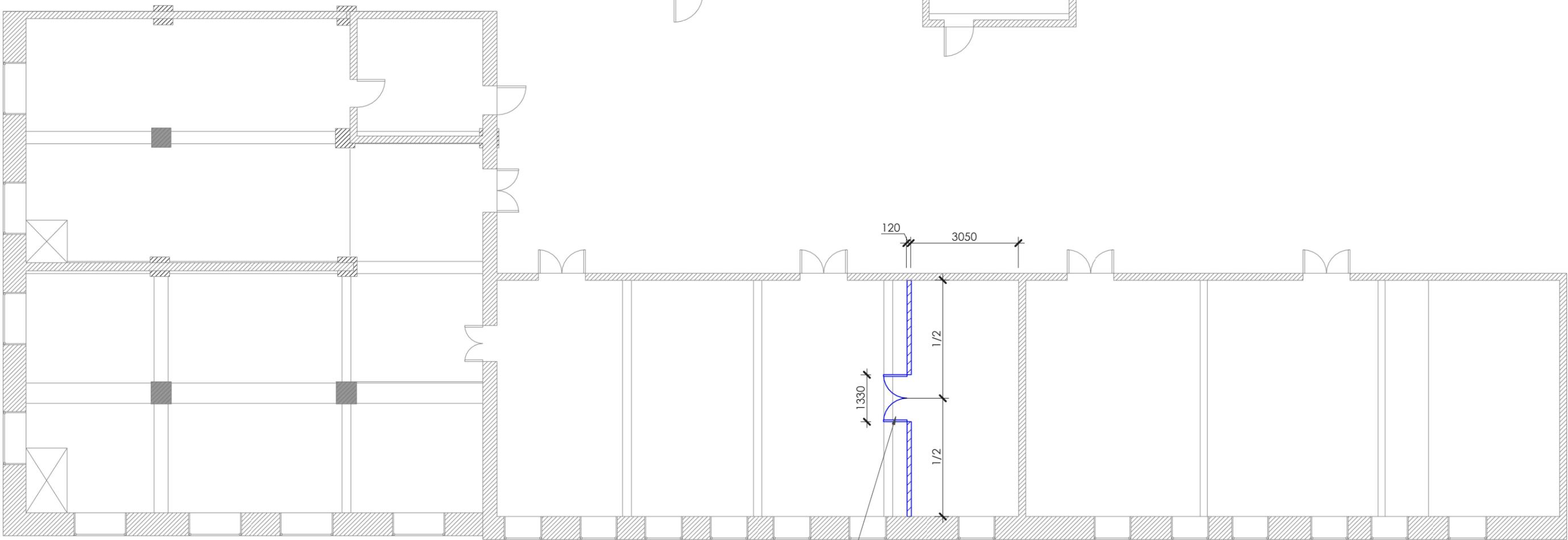
Ширину монтажного проема двери уточнить в технической документации
