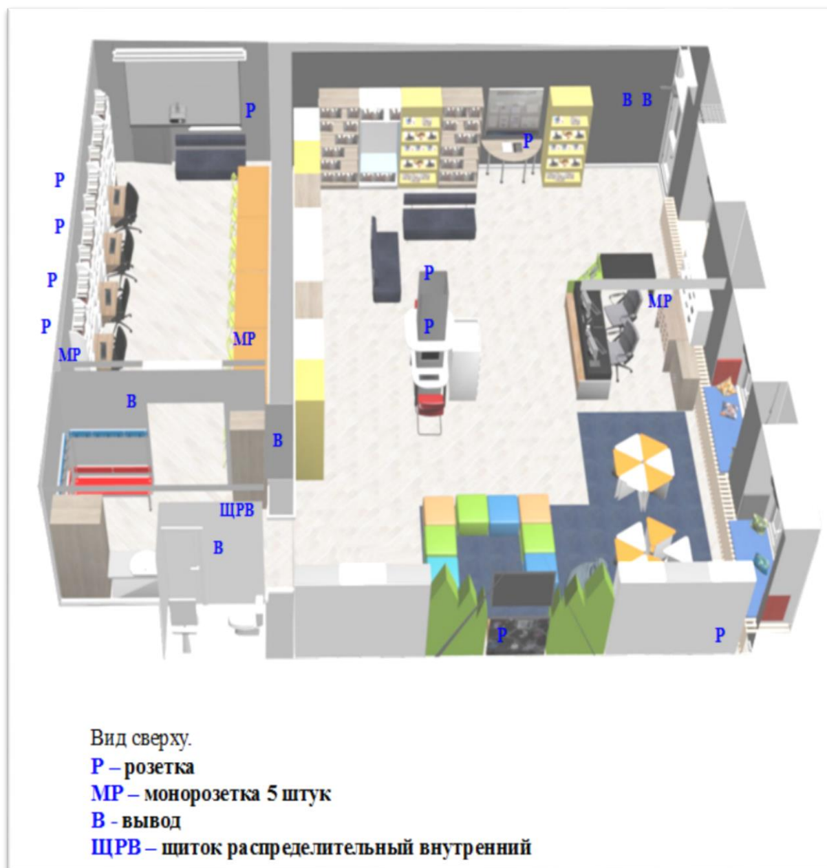
Рис. 4. План расстановки электрических розеток и выводов.
